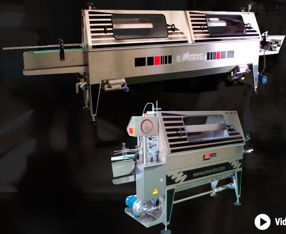
Equipo diseñado para la dosificación de líquidos de gobierno mediante sistema de rebose o cascada, fácilmente adaptable a distintos rangos de producción y formatos de envases.
