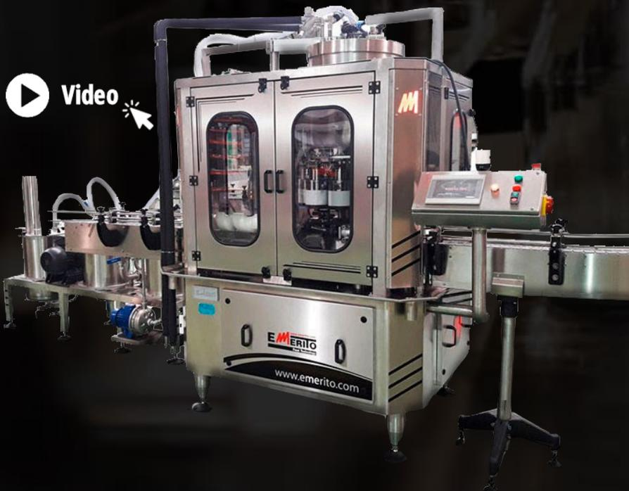
Maschine in Rotationsausführung für die Abfüllung von Abdeckflüssigkeiten (Öl, Essig, Salzlake, Wasser) mit der Vakuum-Technologie. Diese Technologie ist in der Regel auf mittlere und große Hersteller ausgerichtet, da die Geschwindigkeit beim Abfüllen von Flüssigkeiten in den Rotationsversionen erheblich gesteigert werden kann.
