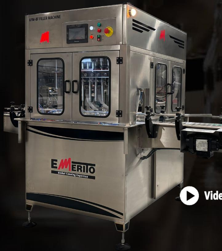
Maschine in linearer und rotierender Ausführung, geeignet für die Abfüllung von Soßen, Pasten oder Flüssigkeiten, unabhängig von der Dichte, ob niedrig oder hoch, mittels Durchflusskontrolle (Volumen).
