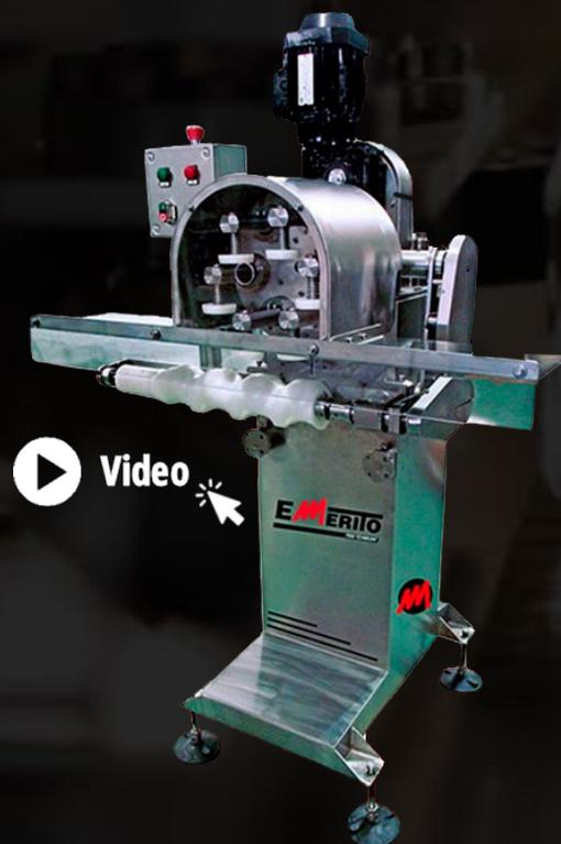
Maschine, die speziell entwickelt wurde, um eine Überfüllung von festen Produkten in Behältern vor dem Verschließen zu vermeiden, indem sie diese kontrolliert in das Innere des Behälters drückt, um dieses Ziel zu erreichen.
