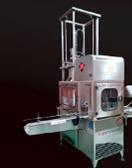
Volumetrischer Füller mit Durchflussmesser
